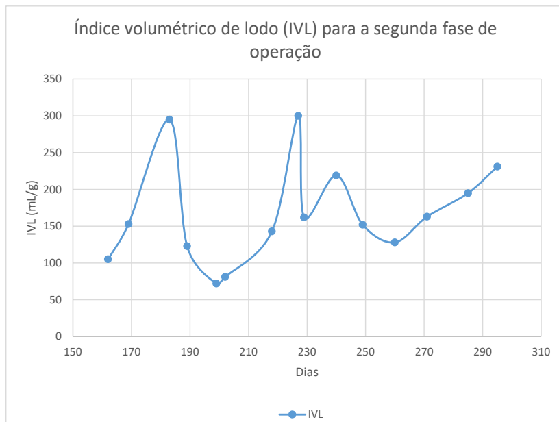
Figura 21: Valores de IVL do lodo durante a segunda fase de operação.
