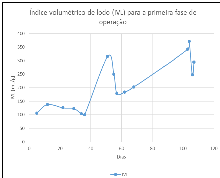
Figura 8: Valores de IVL do lodo durante a primeira fase de operação.
